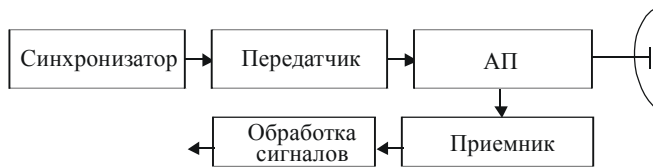
Рис.2.1. Принцип действия РЛС
