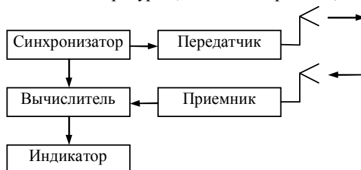
Рис.3.17. Блок-схема радиовысотомера больших высот
